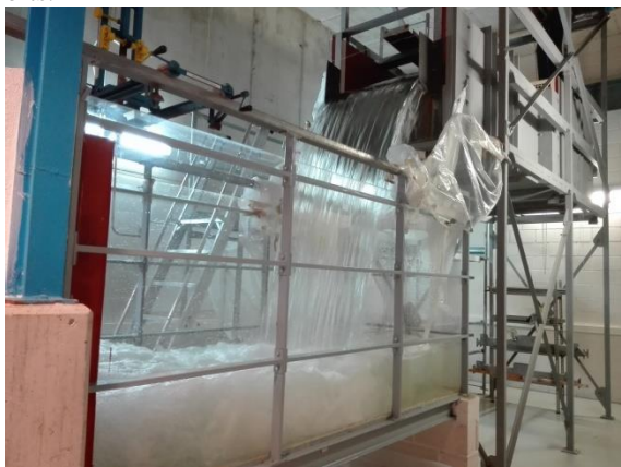
Figura 1. Infraestructura del laboratorio para el estudio de chorros turbulentos y bifásicos.
